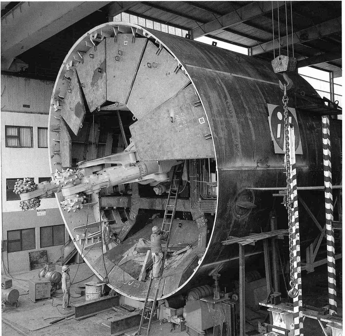
Aspecto de las rozadoras de excavación y vista de frente del escudo.
